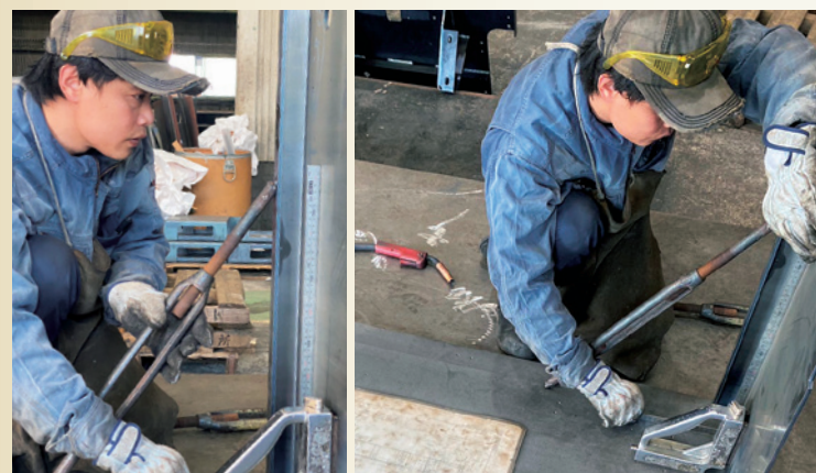
機器を乗せる台盤の図面に合わせて製缶する作業
